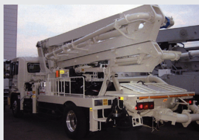
コンクリートポンプ車
