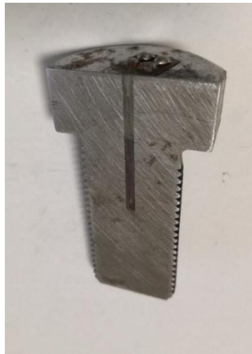
図4 ゲージ長の短い（ゲージ長 0.2 mm）ひずみゲージによる測定（2 ゲージ法）
