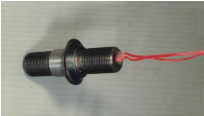
図4 ゲージ長の短い（ゲージ長 0.2 mm）ひずみゲージによる測定（2 ゲージ法）
