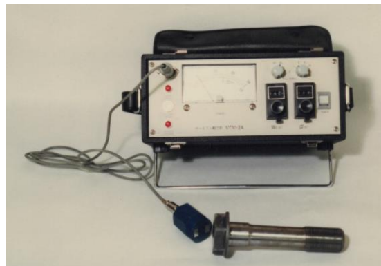
図7 磁気軸力計（芝浦製作所製 MTM-2A）
