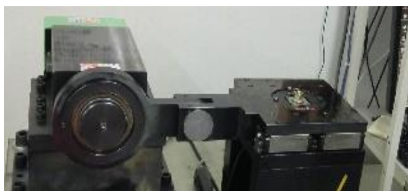
図1 ユンカー式（軸直角振動）ゆるみ試験機
