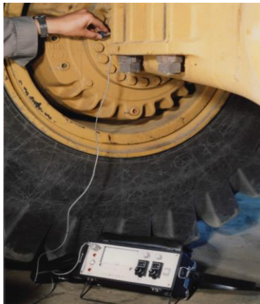
図 19 軸力低下傾向の測定
