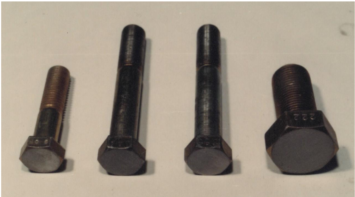
図 8 磁気軸力測定用ボルト頭部の平滑加工
