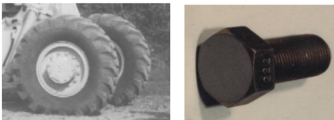
図 14 ハブボルトとその装着状況
